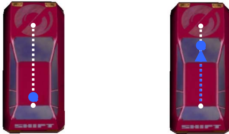
Figura 68 : Punto de giro móvil en los vehículos
